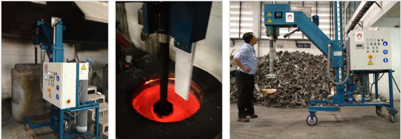
Abbildung 14. MTS 1500 an einem gasbeheizten Tiegelofen zum Einschmelzen von AlSi7Mg-Spänen
