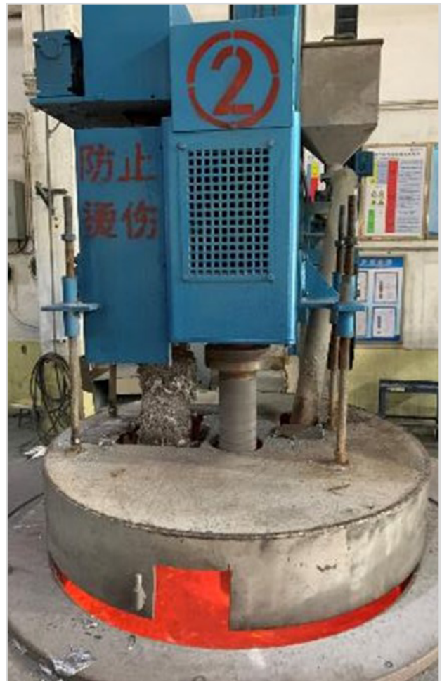
Abbildung 11. MTS 1500 Behandlung in einer Kolbengießerei
