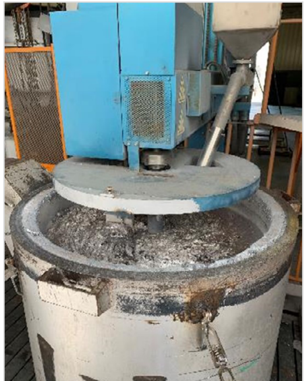
Abbildung 9. MTS 1500 in der Druckgießerei
